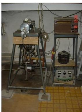
Рисунок 1 – Общий вид сдвигового прибора.
