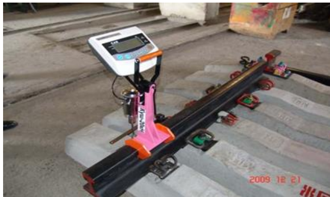
Рисунок 2 – Прибор «Күш-20кН» для определения усилия прижатия всех видов упругих клемм
