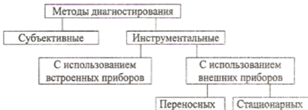
Рисунок 1 – Структурная схема методов диагностирования двигателей
