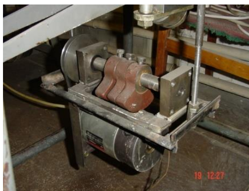
Рисунок 2 – Общий вид вращательного вибратора.
