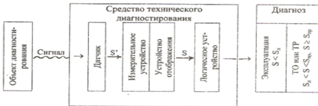
Рисунок 2 – Диагностирование состояния деталей цилиндропоршневой группы двигателей ЯМЗ
