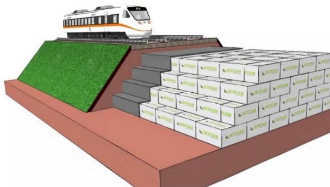
1 сурет – Теміржол астына орнатылған geofoam [6]
