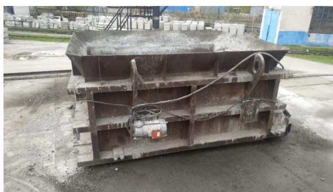
Рисунок 3 – Опалубка квадратного звена ЗП 10.100 сечением 2,0х2,0м
